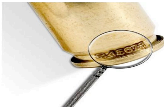
Figura 6: Ejemplo de marcas láser en munición de armas pequeñas de la Policía Federal de Brasil. 17
